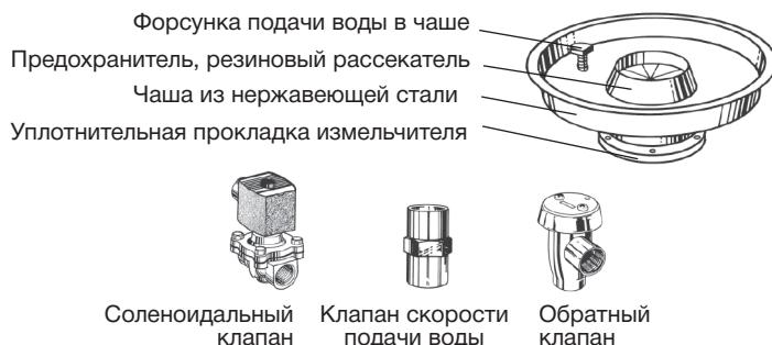
Для стандартного подключения чаши из нержавеющей стали и измельчителя пищевых отходов необходимо:
